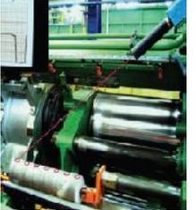
Infrarotthermometer für Pressbolzen
