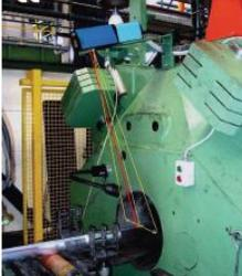
Infrarotthermometer für den Profilaustritt
