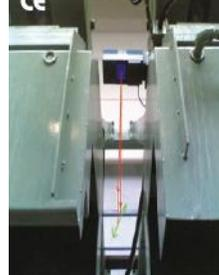
**Infrarotthermometer für Aluminium**
